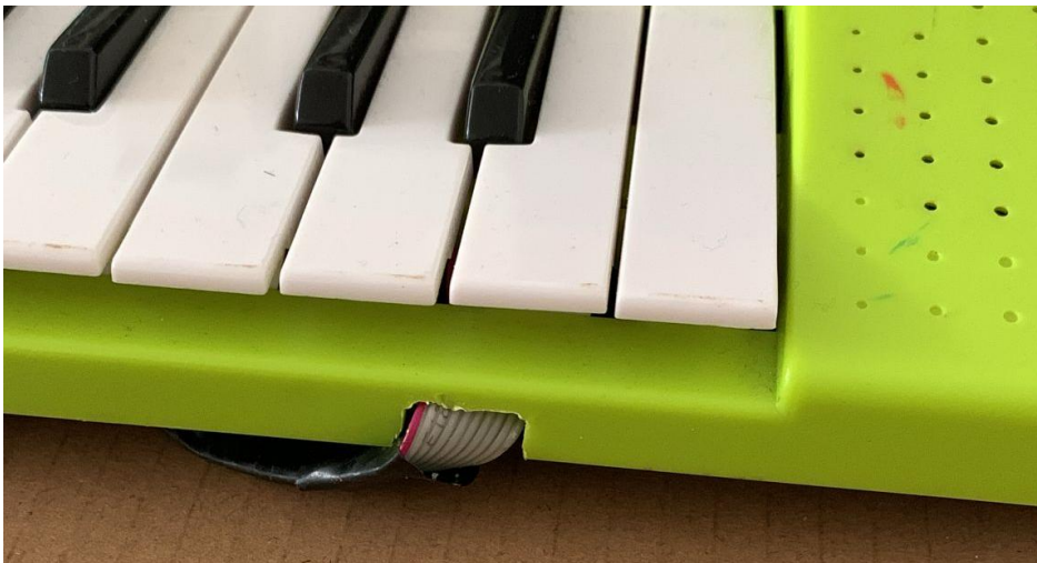
Imagem 3: Buraco feito na carcaça do piano para passagem dos fios
