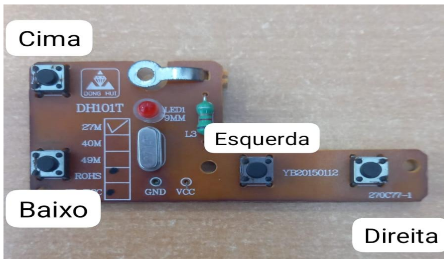
Imagem 2: Fotografia da placa de circuito interior do comando
