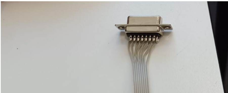
Imagem 5: Fotografia da ficha DB15 soldada com todos os fios.
