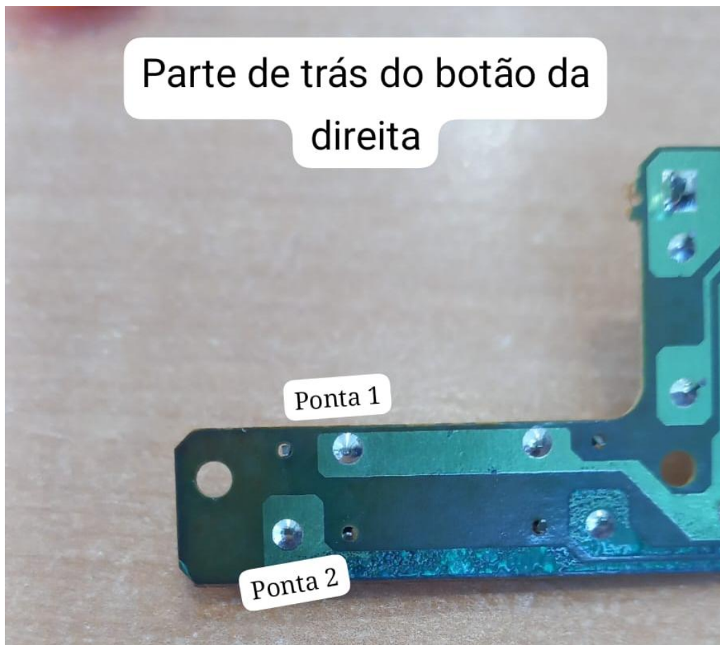
Imagem 3: Fotografia da parte traseira do botão e identificação das pontas de um.
