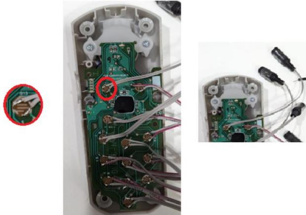
*Figura 4 - conexão dos cabos à placa*
