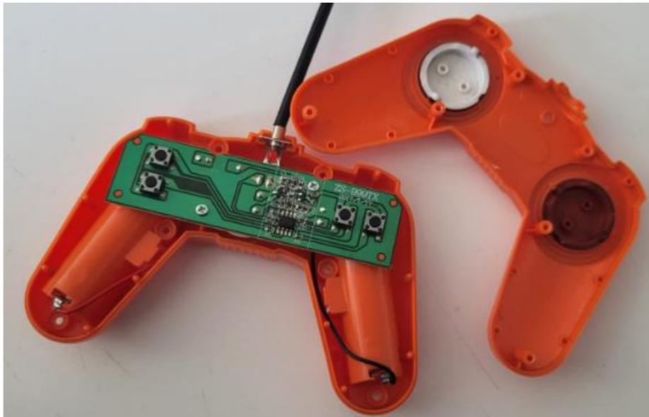
Figura 3 – imagem do comando do brinquedo desmontado
