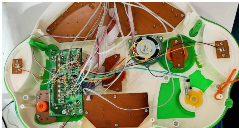
figura 7 – interior do brinquedo depois da soldagem
