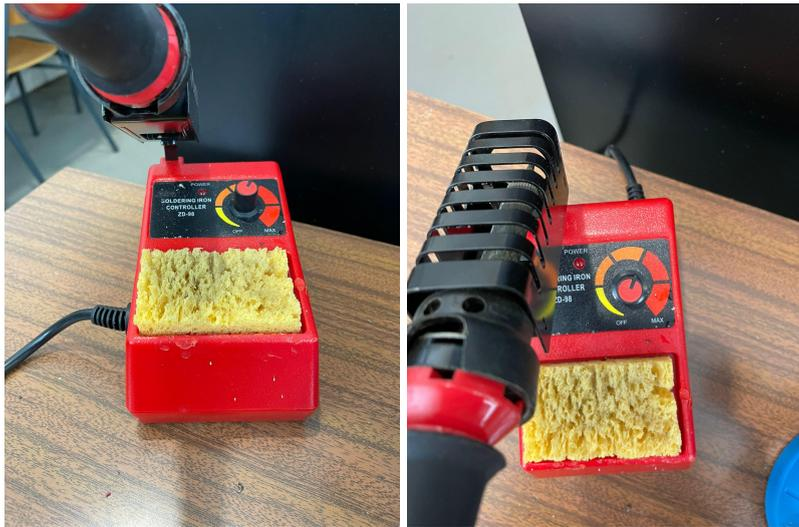
*Figura 2 - Estação de soldadura*
