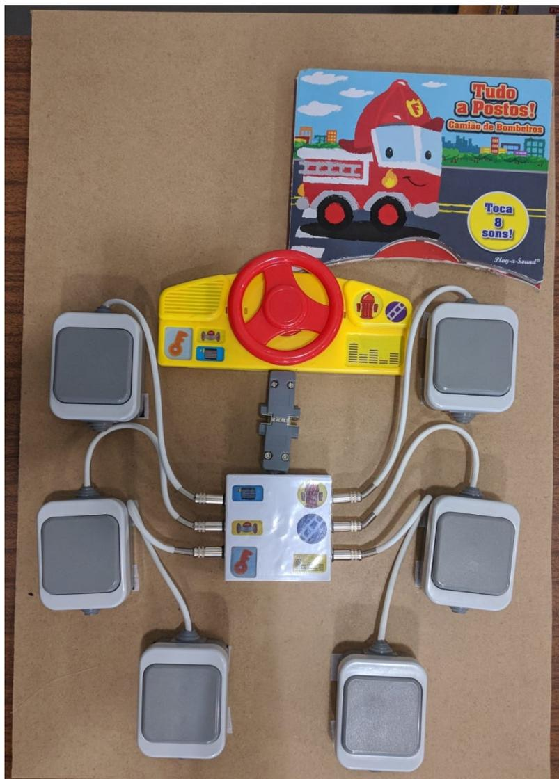
*figura 18 - Montagem final do Livro dos Bombeiros Adaptado*
